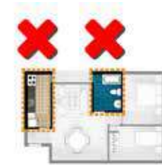
NO POSEE SISTEMA DE EXTRACCIÓN FORZADA EN LOS RECINTOS HÚMEDOS
